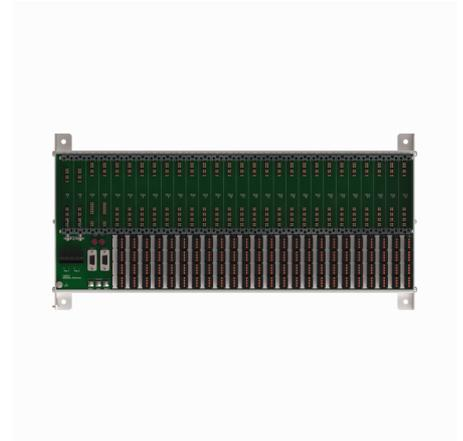
Der Modulträger MT24-N besteht aus einer Backplane und dem eigentlichen Trägersystem. Er dient zur Aufnahme von zwei Gateways, zwei Netzteilen sowie 24 E/A-Modulen. Es können so bis zu 192 binäre Ein-/Ausgänge oder 96 analoge Ein-/Ausgänge bzw. jede Mischform an den Modulträger angeschlossen werden.
