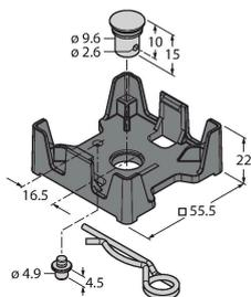
Halterung mit Federsteckerbefestigung für Datenträgerbauform Q51. Die Verwendung des Sicherungsstiftes 4.5mm gewährleistet einen Schutz des Datenträgers vor Verdrehen. Zur Montage auf Metall geeignet. Zum wiederholten Einsatz in Hochtemperatur geeignet. Nur zur einmaligen Montage (Einrasten des Datenträgers in die Halterung) geeignet. Durch die Verwendung der Halterung ergibt sich ein Abstand von Metall zum Datenträger von 12mm.
