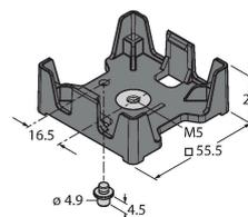
Halterung mit M5-Gewindehülse zur Schraubbefestigung von Datenträgerbauform Q51. Die Verwendung des Sicherungsstiftes 4.5mm gewährleistet einen Schutz des Datenträgers vor Verdrehen. Zur Montage auf Metall geeignet. Zum wiederholten Einsatz in Hochtemperatur geeignet. Nur zur einmaligen Montage (Einrasten des Datenträgers in die Halterung) geeignet. Durch die Verwendung der Halterung ergibt sich ein Abstand von Metall zum Datenträger von 12mm.
