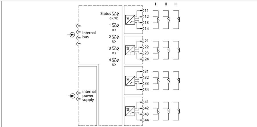
Das Eingangsmodul TI41-N dient zum Anschluss von 2-, 3- und 4-Leiter-Temperaturfühler der Typen Pt100, Ni100, Cu50 und Cu100.
