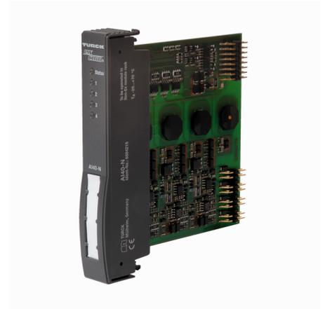
Das Eingangsmodul AI40-N dient zum Anschluss von 2-Leiter-Messumformern (aktiver Eingang = speisend / Geber passiv) und von 4-Leiter-Messumformern (passiver Eingang = nicht speisend / Geber aktiv).
