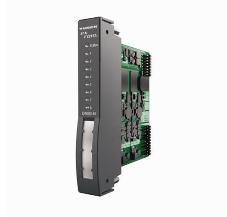
Das Ein-/Ausgangsmodul DM80-N dient zum Anschluss von NAMUR-Sensoren (DIN EN 60947-5-6) und Aktuatoren. Werden mechanische Kontakte angeschlossen, ist bei aktivierter Drahtbruch- oder Kurzschlussüberwachung eine entsprechende Widerstandsbeschaltung (WM1, Ident-Nr. 0912101) vorzunehmen.
