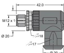
Konfektionierbarer Stecker, M12 x 1, gewinkelt, 5-polig, Schraubklemmanschluss, Leitungsdurchlass 4.0 bis 8.0 mm, Adernquerschnitt/Klemmvermögen 0.25 bis 1.5 mm<sup>2</sup>, Kunststoffgehäuse, Metallüberwurfschraube
