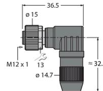
Konfektionierbare Kupplung, M12 x 1, gewinkelt, 4-polig, Schneidklemmanschluss, Leitungsdurchlass 4.0 bis 5.1 mm, Adernquerschnitt/ Klemmvermögen 0.14 bis 0.34 mm<sup>2</sup>, Kunststoffgehäuse, Metallüberwurfmutter
