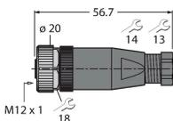
Konfektionierbare Kupplung, M12 x 1, gerade, 4-polig, Schraubklemmanschluss, Leitungsdurchlass 4.0 bis 6.0 mm, Adernquerschnitt/ Klemmvermögen 0.25 bis 0.75 mm<sup>2</sup>, Kunststoffgehäuse, Metallüberwurfmutter
