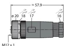
Konfektionierbare Kupplung, M12 x 1, gerade, 12-polig, Lötkontakt, Leitungsdurchlass 6.0 bis 8.0 mm, Adernquerschnitt/ Klemmvermögen 0.14 bis 0.25 mm<sup>2</sup>, Kunststoffgehäuse, Metallüberwurfmutter
