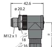
Konfektionierbarer Stecker, M12 x 1, gewinkelt, 8-polig, Schraubklemmanschluss, Leitungsdurchlass 6.0 bis 8.0 mm, Adernquerschnitt/ Klemmvermögen 0.14 bis 0.50 mm<sup>2</sup>, Kunststoffgehäuse, Metallüberwurfschraube
