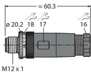
Konfektionierbarer Stecker, M12 x 1, gerade, 8-polig, Schraubklemmanschluss, Leitungsdurchlass 6.0 bis 8.0 mm, Adernquerschnitt/Klemmvermögen 0.14 bis 0.50 mm<sup>2</sup>, Kunststoffgehäuse, Metallüberwurfschraube
