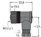
Konfektionierbare Kupplung, M12 x 1, gewinkelt, 5-polig, Schraubklemmanschluss, Leitungsdurchlass 4.0 bis 6.0 mm, Adernquerschnitt/Klemmvermögen 0.14 bis 0.75 mm<sup>2</sup>, Kunststoffgehäuse, Kunststoffüberwurfmutter
