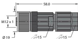
Konfektionierbare Kupplung, M12 x 1, gerade, 5-polig, Push-In-Anschluss, Leitungsdurchlass 4.0 bis 8.0 mm, Adernquerschnitt/Klemmvermögen 0.14 bis 0.75 mm<sup>2</sup>, Kunststoffgehäuse, Metallüberwurfmutter
