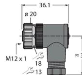
Konfektionierbare Kupplung, M12 x 1, gewinkelt, 5-polig, Schraubklemmanschluss, Leitungsdurchlass 4.0 bis 6.0 mm, Adernquerschnitt/Klemmvermögen 0.25 bis 0.75 mm<sup>2</sup>, Kunststoffgehäuse, Metallüberwurfmutter
