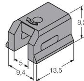
Klemmstück zur Montage von Magnetfeldsensoren auf
