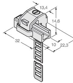
Klemmstück zur Montage von Magnetfeldsensoren auf
