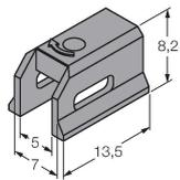
Klemmstück zur Montage von Magnetfeldsensoren auf
