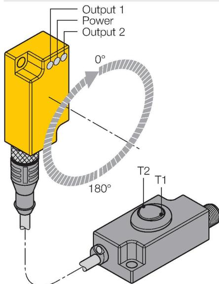
Programmierung der Schaltpunkte mittels Teach-Adapter TX1-Q20L60
